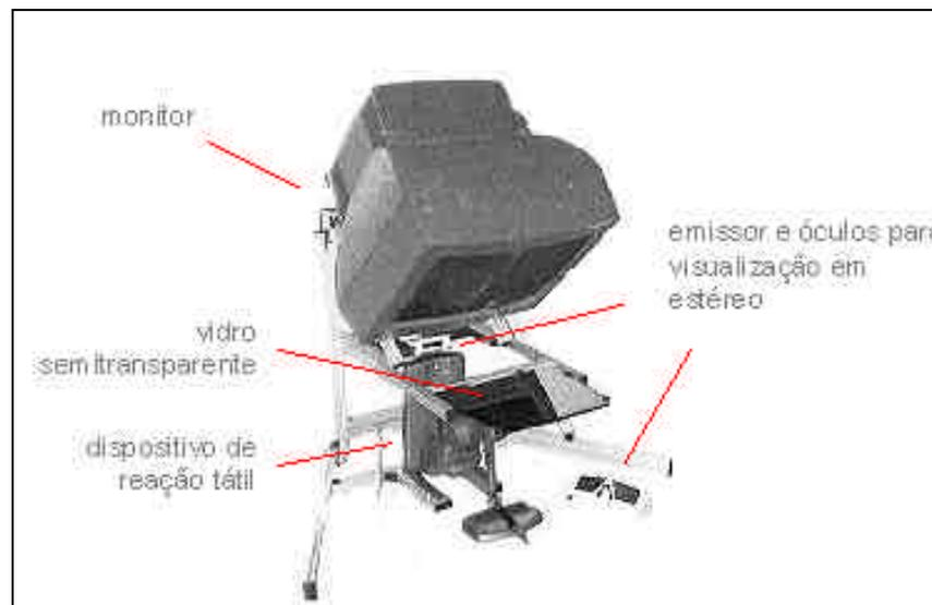
Figura 33: Esquema de montagem e disposição de equipamentos em uma mesa de visualização (<http://magma.reachin.se>).
