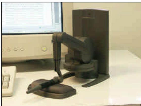
Figura 21: O dispositivo háptico Phantom Desktop.
